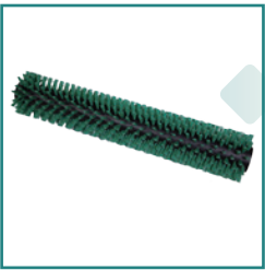
滚刷-PBT材质 硬度中等，回弹力较好，不吸水，耐磨、耐酸碱及油脂，适用于重油污及酸碱类的特殊场景
